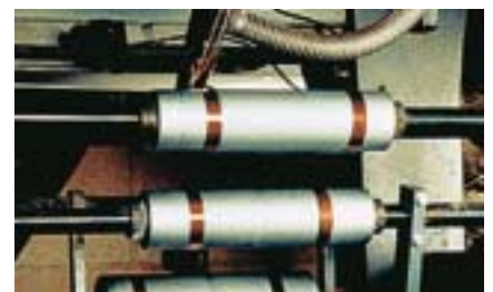
Výroba a zpracování fólií: Přizpůsobivé 3M pásky s fólií PTFE pomáhají pohybu pásů materiálu v mnoha typech výroby a zpracování fólií.
