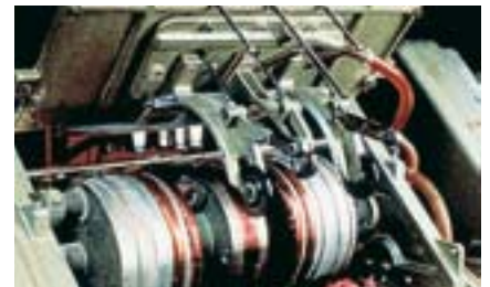
Poštovní tisk: 3M pásky s PTFE fólií se používají v tomto válci plnicí stanice, aby se tištěné kusy hladce pohybovaly přes sešivačku (díky minimálnímu tření).
