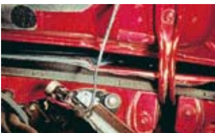
Omezení skřípání: 3M pásky s UHMW-PE fólií pomáhají omezovat skřípání a řinčení v automobilech tím, že vytvoří efekt „klouzající desky“ mezi dvěma nekompatibilními vrstvami.
