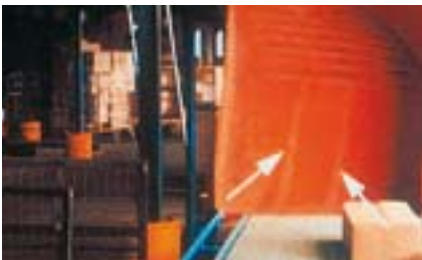
Potažení skluzů: Kartónové krabice klouzají mnohem snadněji po skluzu potaženém UHMW-PE páskou.
